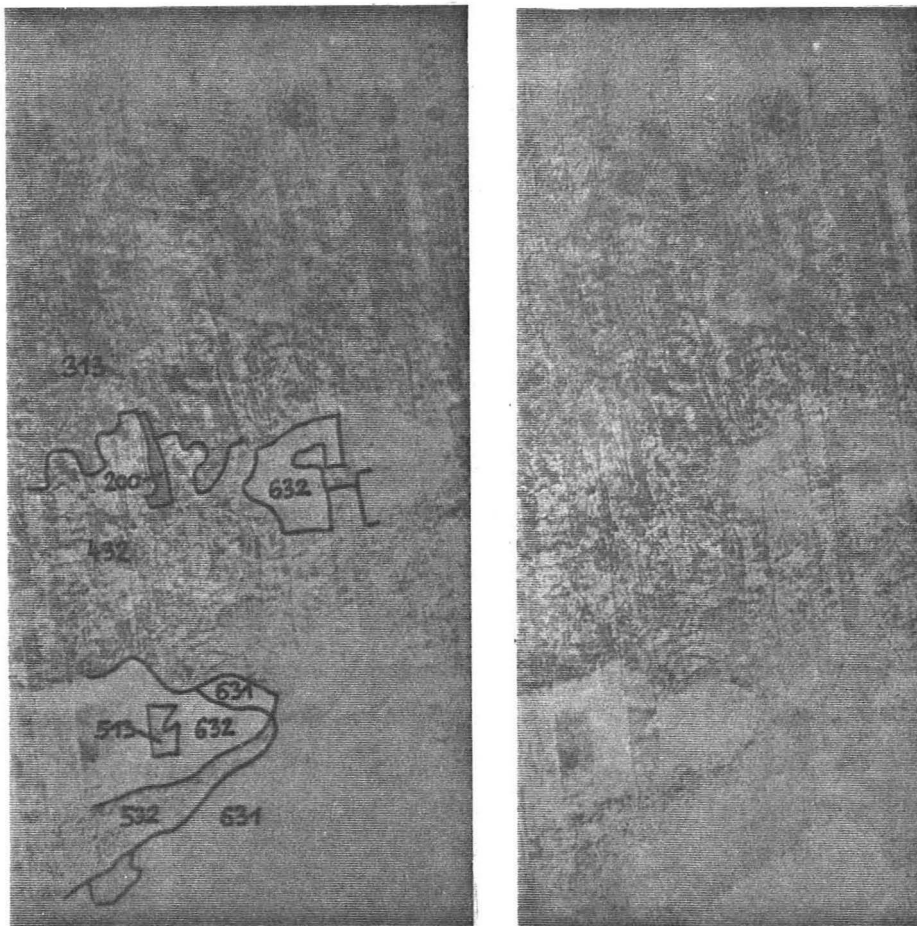
Abb. 4.14 Schlüsselstereogramm für die Klassifikation von Schilfbeständen am Neusiedler See, Ausschnitt aus dem Farb-IR-Luftbildmodell Bildnr. 248, 249; Streifen 16. M = ca. 1:12700. Beachte Hinweis Kap. 6.3.!
