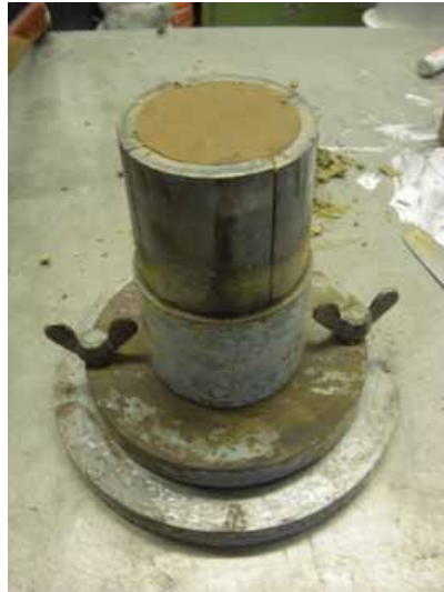
Abb. 3.21: Proctortopf Olympia zur Bestimmung der einfachen Proctordichte
