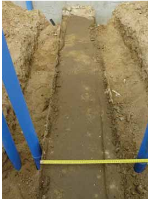
Abb. 3.35: Zonierter Dammaufbau mittels Dichtwand im Dammkörper.
