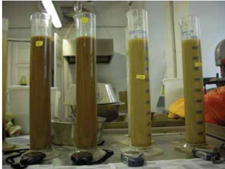
Abb. 3.9: Schlämmanalyse zur Ermittlung der Korngrößenverteilung im Feinkornbereich
