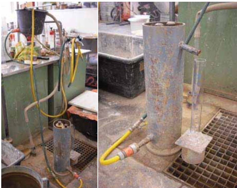
Abb. 3.18: Ermittlung der Wasserdurchlässigkeit mit konstanter Druckhöhe
