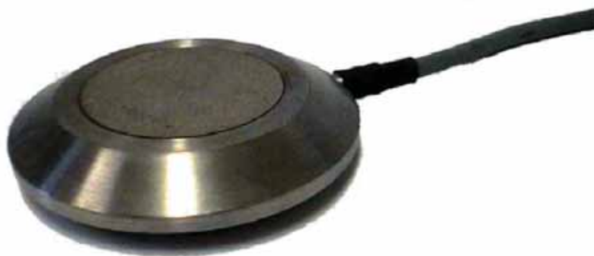
Abb. 3.47: Porenwasserdruckgeber Typ EPK 4/7/1,5 K der Fa. Glötzl
