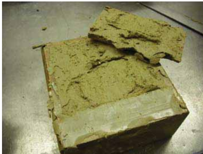
Abb. 3.15: Bodenprobe nach dem Wiener Routinescherversuch
