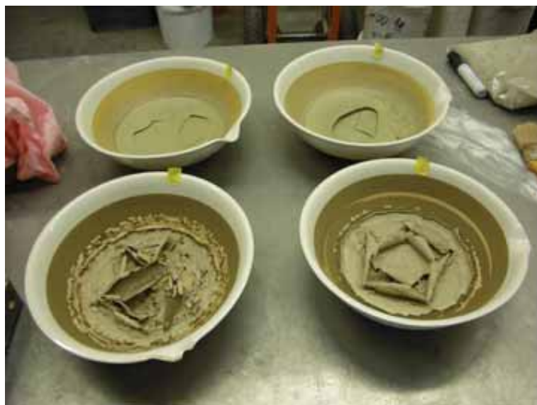
Abb. 3.10: Trockenmasse der Schlämmanalyse nach Trocknung bis zur Massekonstanz
