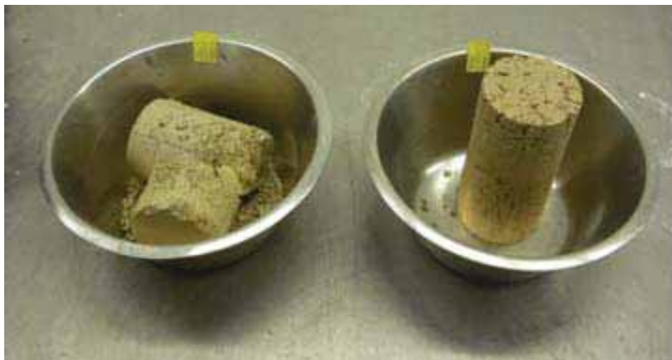
Abb. 3.22: Einzelproben eines Proctorversuchs im Anschluss an die Trocknung bis zur Massekonstanz
