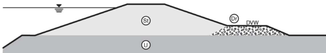
Abb. 2.3: Schematischer Querschnitt eines 2-Zonen-Dammes: Stützkörper (St), Drainagekörper (Dr), Dammverteidigungsweg (DVW), Untergrund (U); (DWA-M 507 [2])
