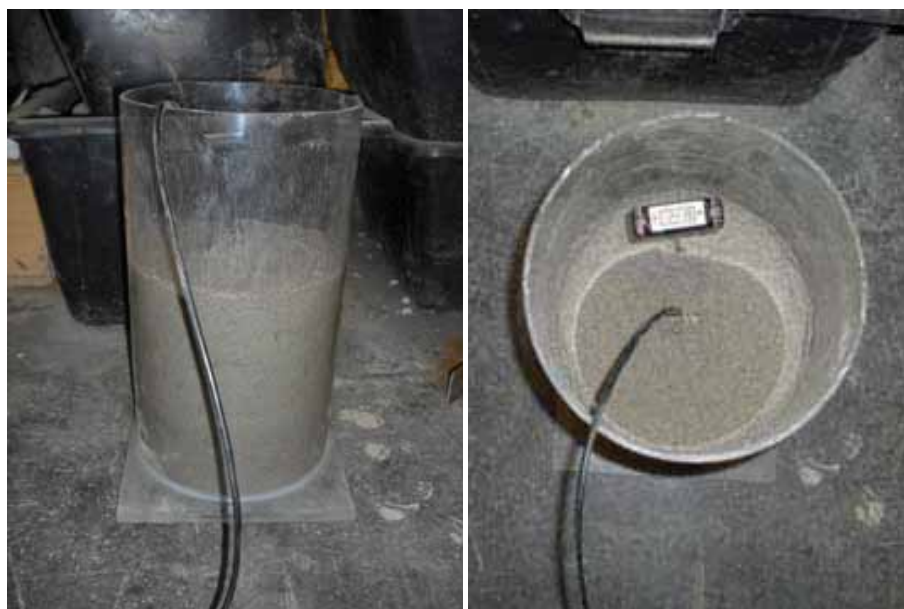
Abb. 3.51: Zylinder zur Kalibrierung der Feuchtesensoren im Labor
