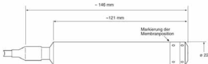
Abb. 3.44: Skizze mit Abmessungen des Niveautransmitter der Fa. Keller, Serie 36 XW
