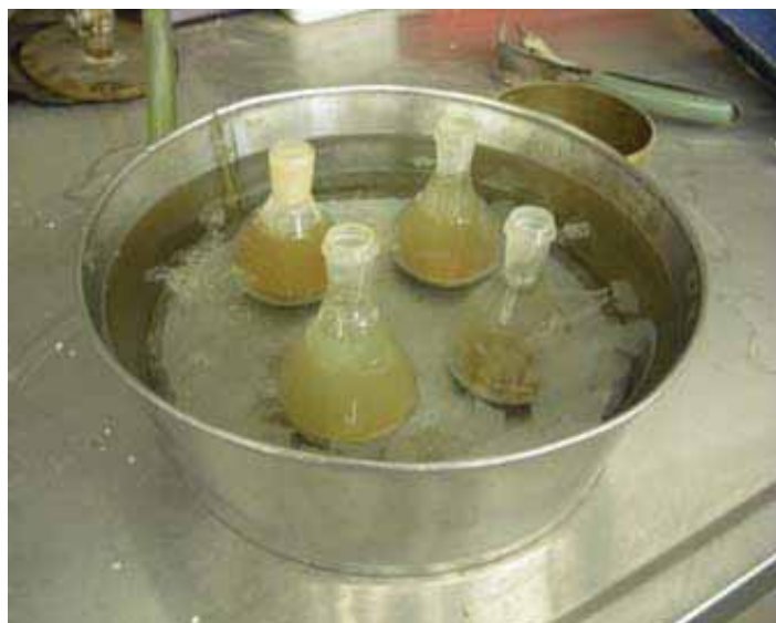
Abb. 3.8: Kapillarpyknometer in der Abkühlphase
