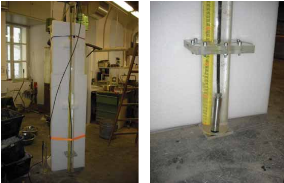
Abb. 3.45: Zylinder zur Kalibrierung der Pegelsonden unter Laborbedingungen (links); Detail vom Einbau der Pegelsonden im Messzylinder (rechts).
