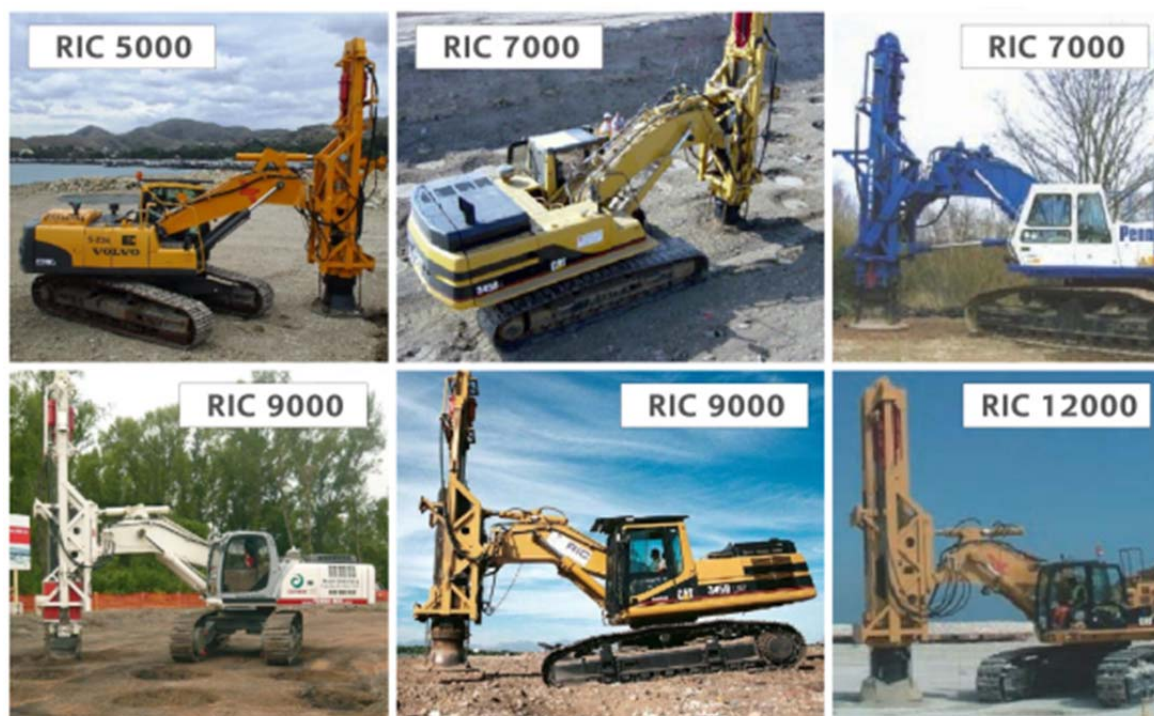
Abb. 24: Verfügbare Impulsverdichter mit verschiedenen Trägergeräten [13, 46] Oben (von links nach rechts): RIC 5000 montiert auf Volvo EC290 in Papua-Neuguinea; RIC 7000 montiert auf CAT 345B in den USA; RIC 7000 montiert auf Daewoo DH450 in Großbritannien Unten (von links nach rechts): RIC 9000 montiert auf New Holland E485B in Österreich; RIC 9000 montiert auf CAT 345B in Südafrika; RIC 12000 montiert auf CAT 365B in Katar
