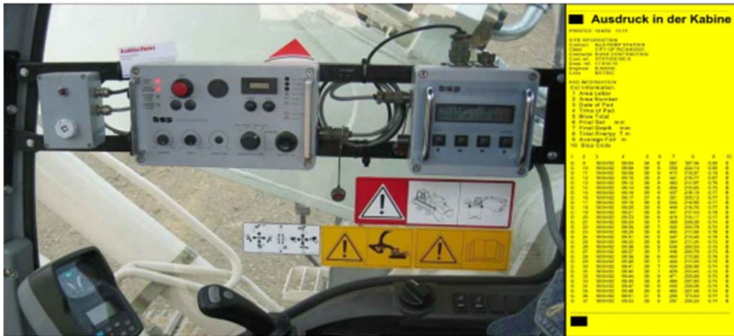
Abb. 25: Datenerfassungssysteme in der Fahrerkabine des Impulsverdichters [46]
