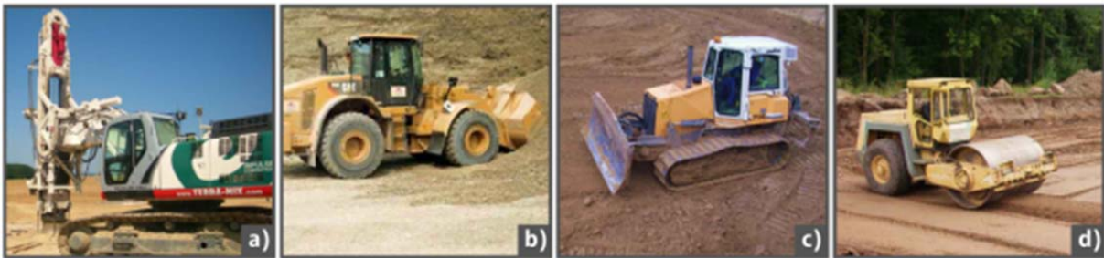
Abb. 39: Erforderliche Baugeräte für Impulsverdichtung [46] a) Impulsverdichter; b) Radlader; c) Schubraupe und d) Vibrationswalze
