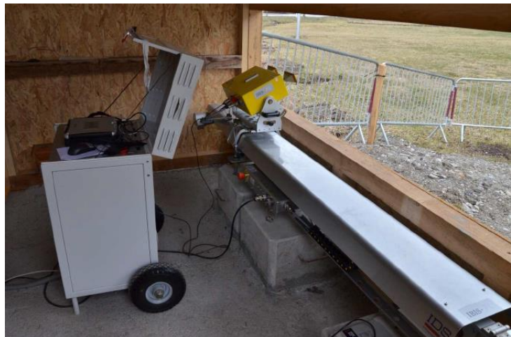
Abbildung 30: InSAR(Interferometric Synthetic Aperture Radar)-Einrichtung zur Hangbeobachtung (Quelle: VALENTIN 2014, S. 17)
