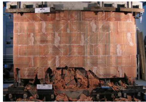
(b) Prüfwand kurz nach dem Versagen
