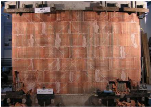
(a) Prüfwand kurz vor dem Versagen
