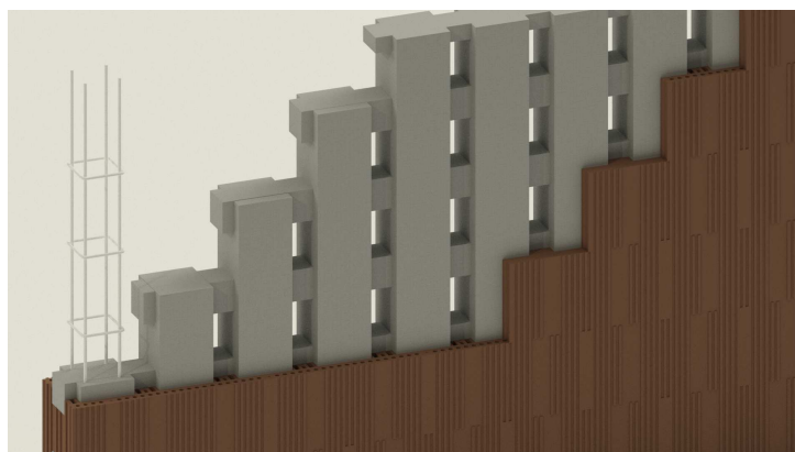
Abb. 1.2: Beispiel für ein eingefasstes Mauerwerk
