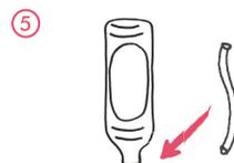
5 Den Schlauch in das Loch im Deckel einsetzen. Der Schlauchteil in der Flasche sollte kurz sein.
