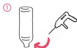
1 In den Flaschendeckel (ausgenommen unterste Flasche) ein kleines Loch bohren. Der Durchmesser sollte etwas kleiner als der Schlauch sein.
