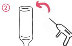
2 In die Flaschenböden (ausgenommen oberste Flasche) mit dem Lochsägeaufsatz eine Öffnung bohren, sodass der Deckel der darüberhängenden Flasche hineinpasst.
