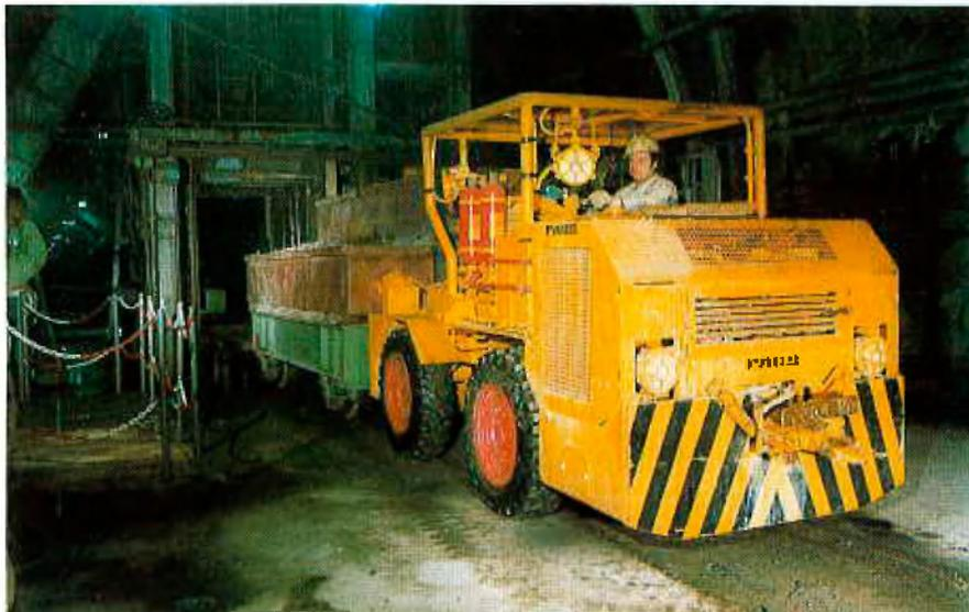
Abb. 7: Luftbereiftes Aufschiebefahrzeug schiebt einen Materialwagen auf den Korb
