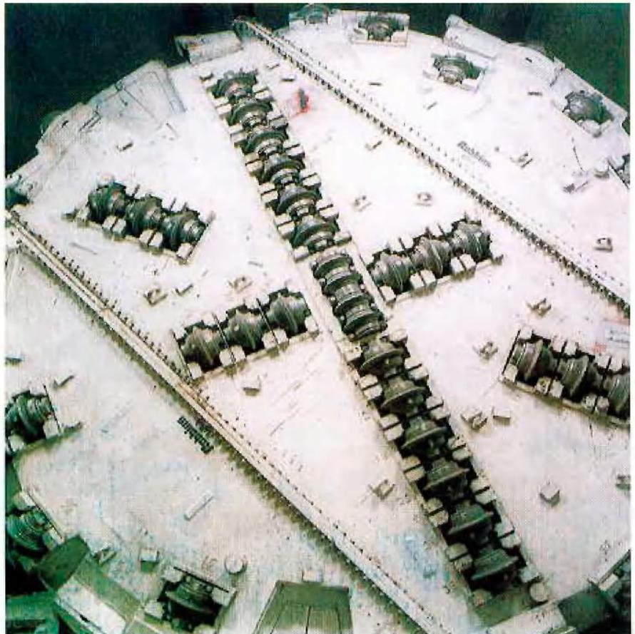
lenlager montierte Bohrkopf wird durch 8 Elektromotore von je 90 kW mit Planetenantrieb gefahren. Daraus resultiert eine Bohrkopfdrehzahl von 3,97 U/M. Der Bohrkopf trägt 46 Diskenmeißel, davon 4 mit 12" und 42 mit 14" Durchmesser. Die maximale Meißelbelastung liegt bei 13 600 kg. Der Vorschubdruck bei max. Arbeitsdruck der Hydraulik beträgt 640 t. Die Maschine hat eine Gesamtlänge von 20 m und ein Gewicht von 280 t.
