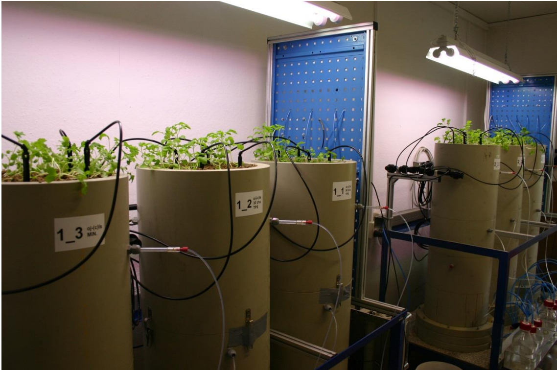
Abbildung 10: Überblick über die Bodensäulenanlage (links 3 Säulen Welzow, rechts 3 Säulen Zinnitz), jeweils von links nach rechts die Varianten MIN, 30 BKS15, 90 BKS15. Foto: A. Rademacher
