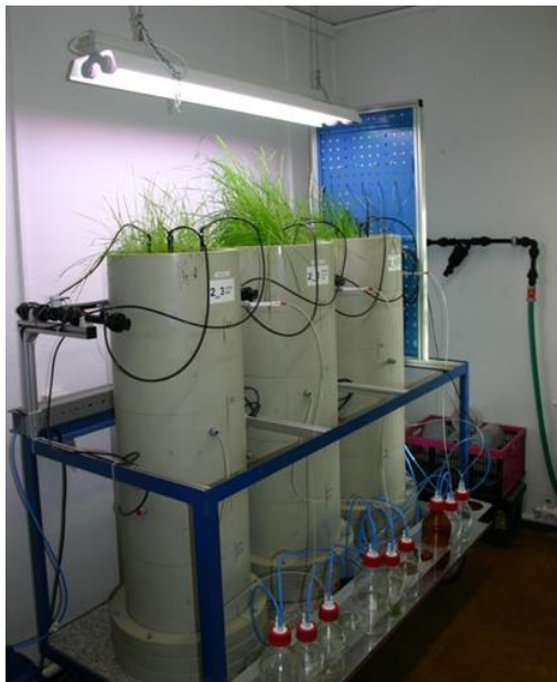
Abbildung 8: Links: Rollwagen mit Bodensäulen; Rechts: Unteres Säulensegment mit TDR-Sonden (Fotos: A. Rademacher)
