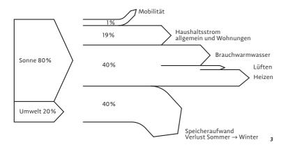
3\_Energieflussdiagramm.Schéma des consommations et ressources.Diagramma dei flussi energetici.
