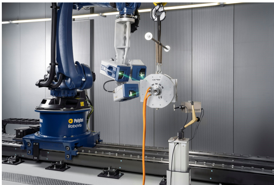
Abbildung 2: Versuchsaufbau zur experimentellen Modalanalyse im RoboVib-Testzentrum.
