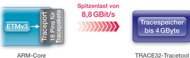
Bild 1: Das Tracetool für die parallele ETMv3 erlaubt eine Datenrate von 8,8 GBit/s bei 16 Pins für die Tracepakete
