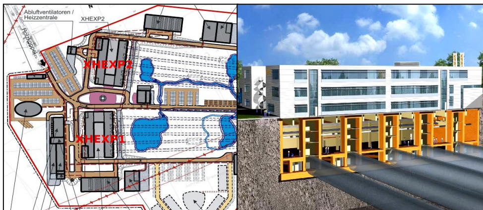
Abbildung 30: Ausschnitt der XFEL-Anlage mit den Experimentierhallen XHEXP1 und XHEXP2 (links) und Bildmontage des Gebäudes mit unterirdischer Experimentierhalle (Beispiel 2005) (rechts)
