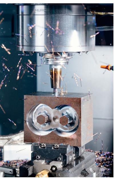
1 Durch das Trochoidalfräsen kann die Standzeit der Werkzeuge bis um ein Zehnfaches verlängert werden, die Bearbeitungszeiten reduzieren sich um 30 bis 40 Prozent © Hurco
