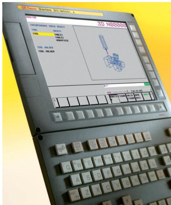
**Interference Check:** Die Anti-Kollisionssoftware betrachtet hier auf dem Monitor die tatsächlichen Bewegungen der Werkzeugmaschine in Echtzeit und vermeidet Kollisionen mit beinahe hundertprozentiger Sicherheit.
