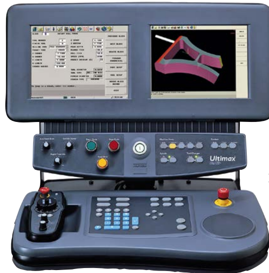
1 WinMax-Steuerung von Hurco: Die Dialogprogrammierung reduziert die Zeit vom Entwurf bis zum fertigen Werkstück (Bild: Hurco)
