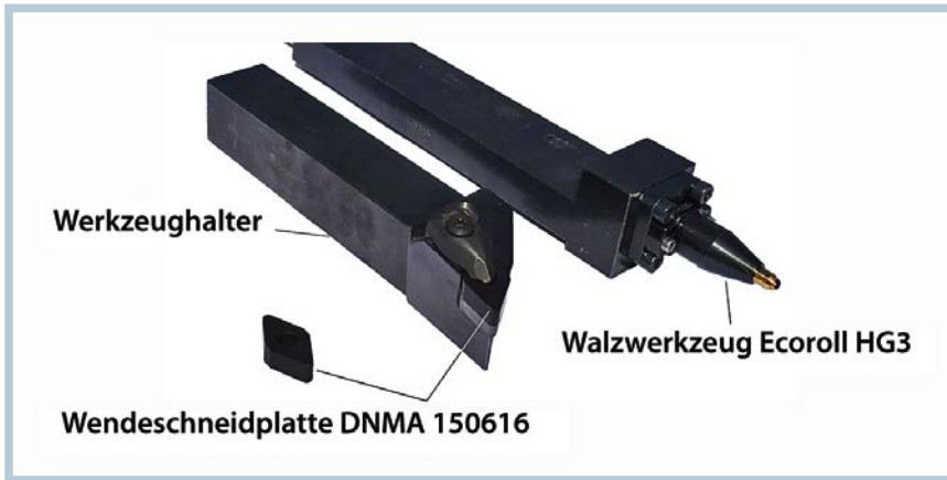
3 Für die Versuche verwendete man ein Drehwerkzeug mit Wendeschneidplatte DNMA 150616TK1001 (links) und ein Walzwerkzeug Ecoroll HG3 (Bild: IFW)
