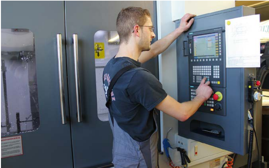
5 Mechaniker Martin Hommel zeigt sich mit der Sinumerik 828D inklusive Operate-Benutzeroberfläche zufrieden: »Wir können dank komfortabler CNC-Funktionen die PreMill VL 1000 mit wenigen Tasten einrichten und einfache Bauteile mit Shopmill schnell und sicher programmieren« (© Siemens)
