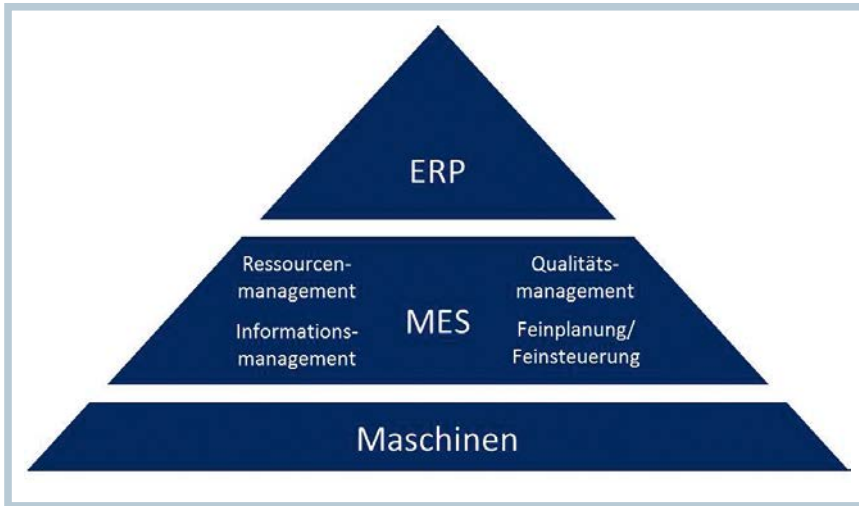
2 Basis für Recherchen zur Industrie-4.0-Fähigkeit von KMU: die Richtlinie VDI 5600 für Vernetzungen in Produktionsunternehmen (© Schumacher)
