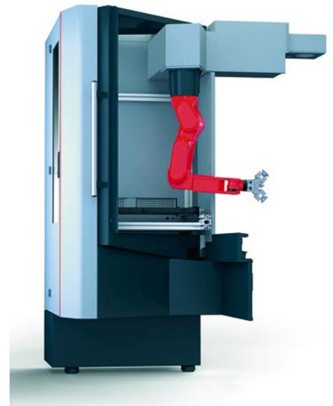
2 Für besonders beengte Verhältnisse gibt es eine Version, bei der das Belademodul eigens als Ecklösung mit quерem Materialfluss gestaltet wurde. Diese Variante zeichnet sich durch eine kreisbogenförmige Roboterraumtür aus und erlaubt einen nahezu uneingeschränkten Zugang zu allen Rüstarbeiten am Beladepplatz (© SW)
