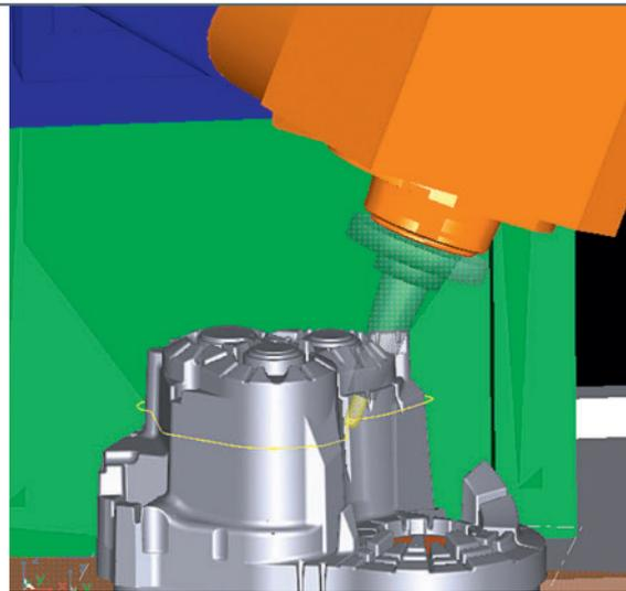
1 ›WorkNC‹ zeigt eine detaillierte Simulation der Bearbeitungssituation. Die Fähigkeit zur Bearbeitungs- und Maschinensimulation unterstützen den Anwender besonders bei komplexen Achsbewegungen, wie sie zum Beispiel bei der 5-Achs-Simultanbearbeitung auftreten
