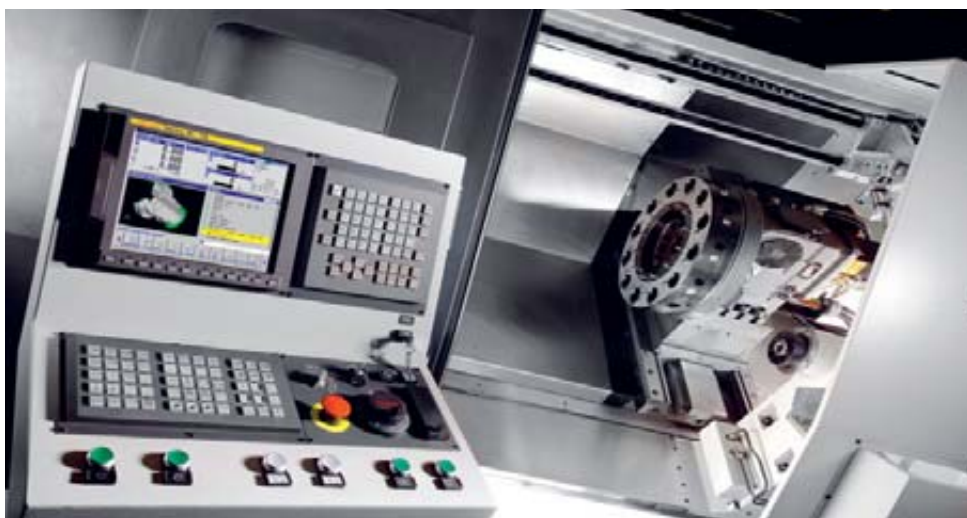
1 Das Drehmodul stellt sämtliche Zyklen für das schnelle und einfache Programmieren eines Drehteils bereit. Dazu zählen Funktionen zum Schruppen und Schlichten, Innen- und Außendrehen, für Plan-, Nuten- und Stechdrehzyklen sowie zum Bohren
