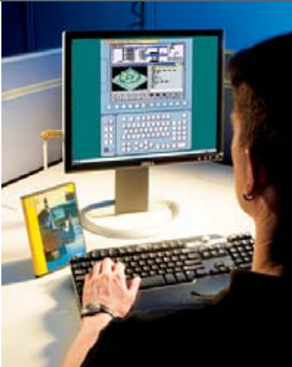
5 Manual Guide i ist eine Programmiersoftware für die Werkstatt, aber erlernen und trainieren lässt sich der Umgang mit ihr auch über Simulator-Software am PC
