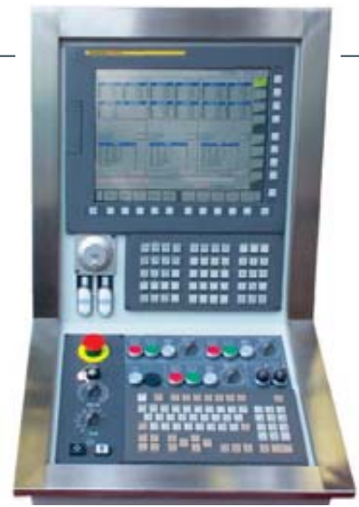
4 Manual Guide i im Einsatz bei der ›Spinner TD 42 Triplex‹: Auf dem 15"-Monitor werden die Bearbeitungsprogramme der drei Revolver nebeneinander angezeigt. Ein zusätzliches Bedienfeld ermöglicht es, jeden Revolver in Einzelschritten einzufahren
