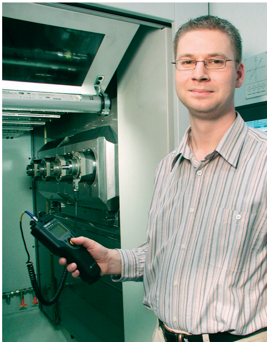
1 Rasche Erkenntnis: Innerhalb weniger Minuten lassen sich mit dem handlichen, transportablen Messgerät die Schwingungen an Hauptspindeln aufnehmen
