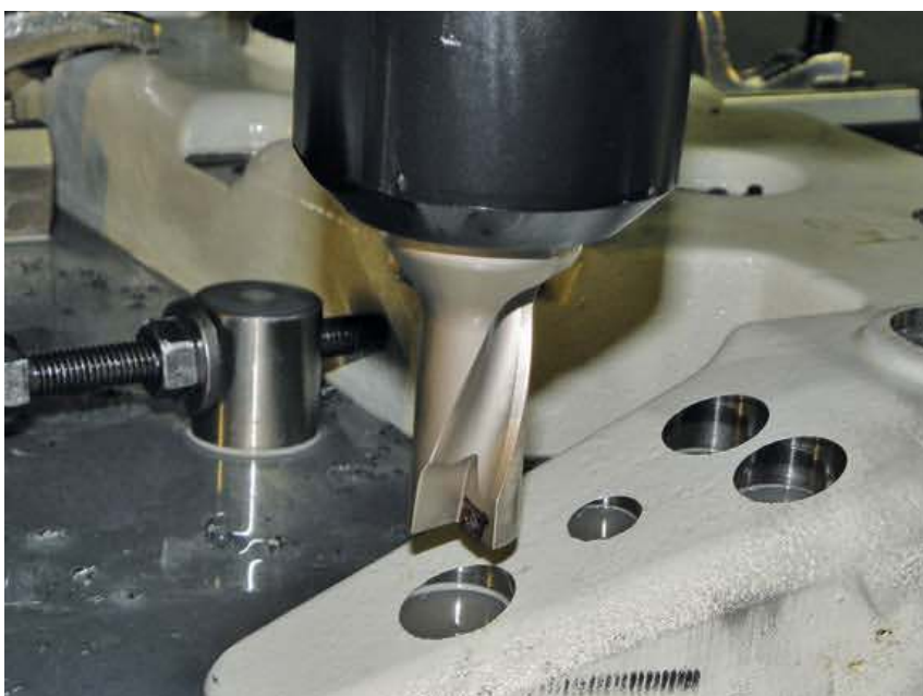
2 Der kurze und steife WDX-Vollbohrer taucht auch in schräge Werkstücke ein, ohne abgedrängt zu werden
