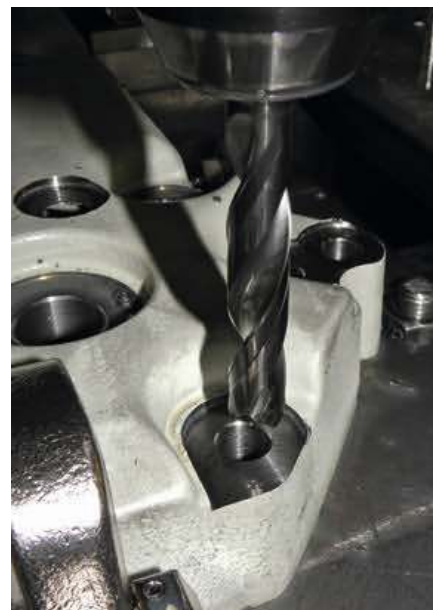
3 Die Kombination aus speziellem Hartmetall, modernem Design und neuer Beschichtung ertüchtigt den SDP-Vollhartmetallbohrer für schnelles Bohren und bislang unerreichte Standzeiten selbst bei Lunkern und unterbrochenem Schnitt. Dieses Werkzeug hat bereits mehr als 20 000 Bohrungen erzeugt!
