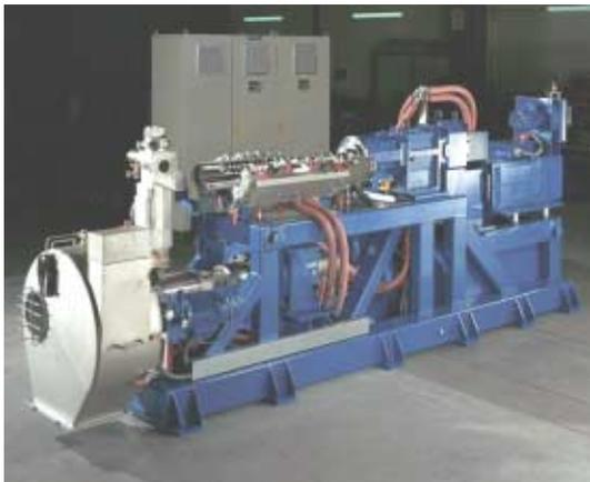
Bild 1. Gesamtansicht der quantec 80, deren Schnecken-durchmesser in der Prozesszone 80 mm beträgt und die gemeinsam mit Verbindungsschacht und Granulierschnecke auf einer Grundplatte anschlussfertig montiert ist
