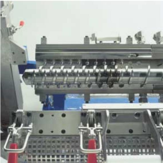
Bild 3. Bei der Schnecke der quantec wird die Lücke zwischen zwei Knetflügeln durch den stromabwärts folgenden Knetflügel überdeckt
