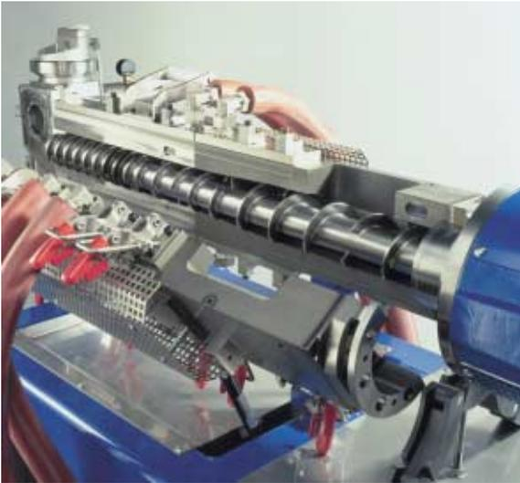
Bild 2. Durch eine große Einzugsöffnung und den im Einzug vergrößerten Schneckendurchmesser nimmt die quantec auch voluminöse Schüttgüter freifließend und ohne Stopfwerk auf
