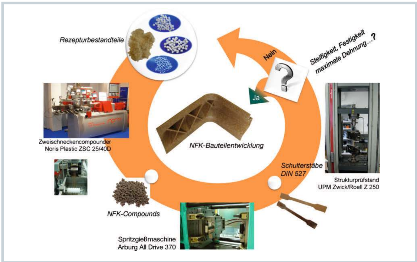
Bild 3. Schematischer Ablauf der Rezepturentwicklung
