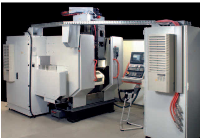
Bild 3. Prototyp einer Werkzeugmaschine zum Laserpolieren, den das Fraunhofer ILT zusammen mit drei Partnern aus Maschinenbau und Lasertechnik entwickelt hat
