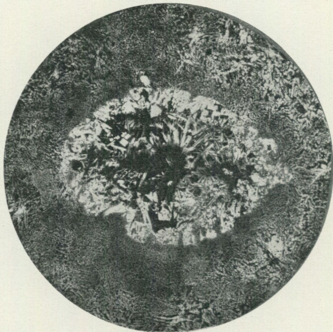
Fig. 2. Aggregat von 3:5-Aluminat und unbestimmtem Aluminat in Schmelzzement von Valle-viken. Gew. Licht; Vergr. 16 \times . 3:5-Aluminat bildet die lichte Aussenzone und ist auch innerhalb derselben als vereinzelte, viereckige Kristalle sichtbar. Das unbestimmte Aluminat bildet radiell gestellte, teilweise sphärolithisch angeordnete Leisten. Schwarz = Perowskitmineral und etwas ged. Eisen. Der lichte Fleck am oberen Rand des Aggregats = Hohlraum im Schliff. Die schwarze Pigmentierung im umgebenden Zement rührt von Perowskitkörnern und etwas ged. Eisen her.
