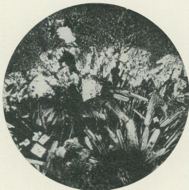
Fig. 3. Oberer Teil desselben Aggregats wie in der Fig. 2. Gew. Licht; Vergr. 65 \times . Die Leisten des unbestimmten Aluminats treten hier durch ihre etwas dunklere Farbe besser hervor. Links und rechts unten sind einige scharf idiomorphe, viereckige Kristalle von 3 : 5-Aluminat (rein weiss) sichtbar. Zwischen den Leisten des unbest. Aluminats sind an mehreren Stellen und besonders im rechten Teil des Bildes feinere Leisten sichtbar, die von den unbest. Aluminat-Kristallen überquert werden. Diese Leisten bestehen aus Gehlenit, der in einer Mehrzahl von Leisten gleichförmig opt. orientiert ist. Oben ist derselbe Hohlraum wie in Fig. 2 sichtbar. Die scharfe äussere Grenze der 3 : 5-Aluminatzone ist deutlich sichtbar. Das teilweise grau gekörnelt Aussehen der 3 : 5-Aluminatkristalle rührt von korrodierten Einschlüssen vom unbest. Aluminat her. Schwarze Kügelchen von ged. Eisen in den Aluminaten sind an mehreren Stellen sichtbar.
