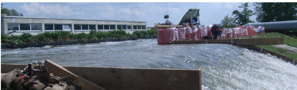
Abb. 33 Überströmung am Versuchsdeich in Biebesheim [RPDA]
