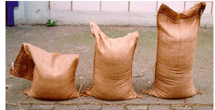
Abb. 60 zu geringe (links), zu volle (rechts) und ideale Sandsackbefüllung (Mitte) [RPDA]
