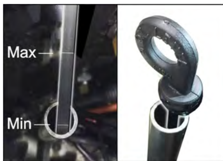
Bild: Mät oljenivån på bensin-/gasmotorn (KM 105/... och KM 125/...)
