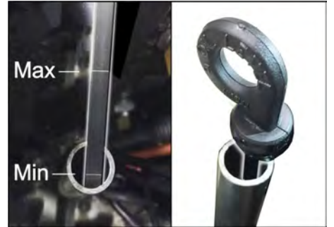
Şekil: Benzinli/gazlı motorda yağ seviyesinin ölçülmesi (KM 105/... ve KM 125/...)
