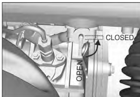
Figure : Fermer le robinet de carburant (moteur diesel)
