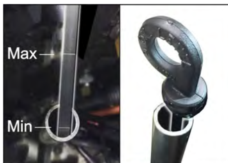
Figure : Mesurer le niveau d'huile du moteur essence/à gaz (KM 105/... und KM 125/...)
