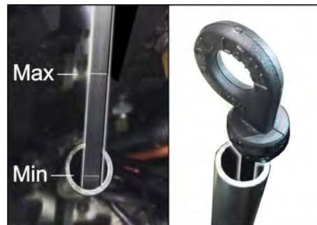
Figura: Medir o nível do óleo em motores a gasolina/gás (KM 105/... e KM 125/...)
