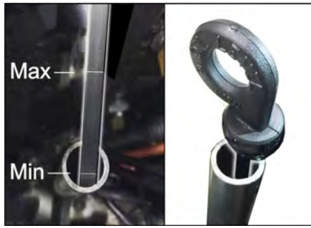
Abbildung: Ölstand messen beim Benzin-/Gasmotor (KM 105/... und KM 125/...)
