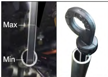
Afbeelding: Oliepeil meten bij benzine-/gasmotor (KM 105/... and KM 125/...)
