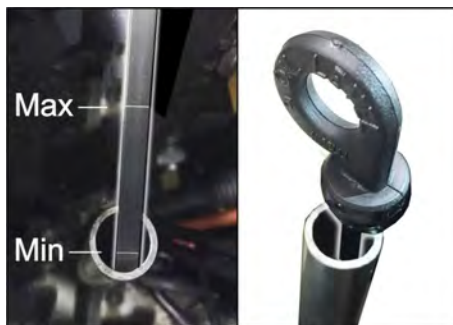
Bilde: Måle oljenivå på bensin-/gassmotor (KM 105/... og KM 125/...)
