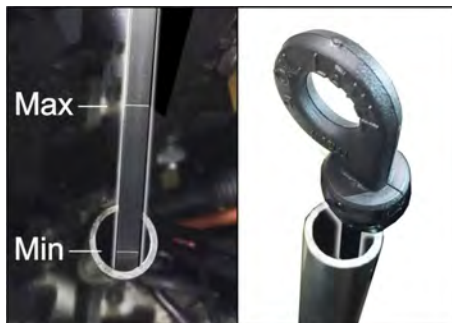
Figur: Måling af olieniveau i benzin-/gasmotor (KM 105/... og KM 125/...)
