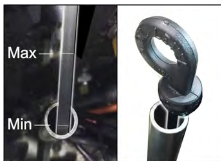
Figura: Misurare il livello dell'olio in motore a benzina/gas (KM 105/... e KM 125/...)
