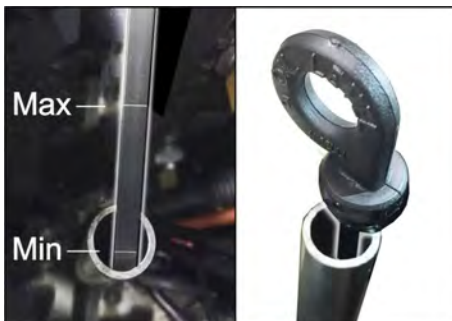
Imagen: Medición del nivel de aceite del motor de gasolina/gas (KM 105/... y KM 125/...)
