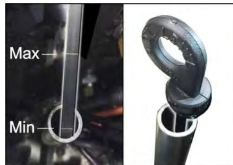
εικόνα: Μέτρηση στάθμης λαδιού σε κινητήρα βενζίνης/αερίου (KM 105/... και KM 125/...)
