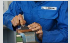
Werkstück mittig einspannen, Kupferschutzbacken verwenden! Sägestelle ankerben.
