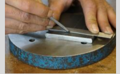
Werkstück mit Stahlmaßstab und Anreißnadel anreißern
