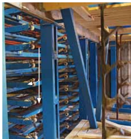
Schnittholz wird per Paternoster von oben angeliefert und in der richtigen Lage mit ausfahrbaren Rollen abgenommen
