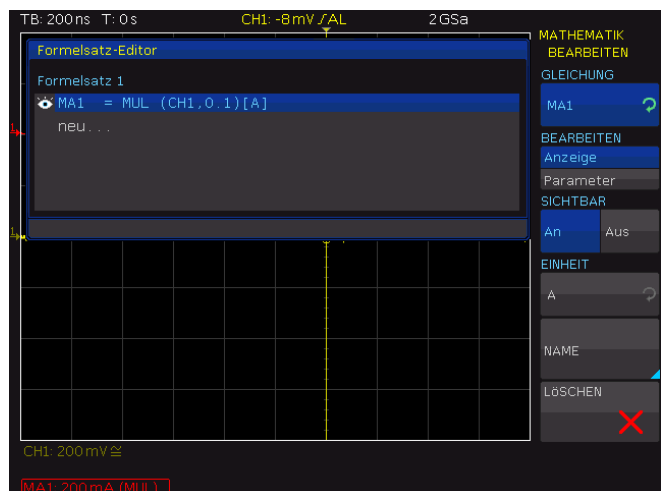
Abb. 9.5: Definition der Stromgleichung
