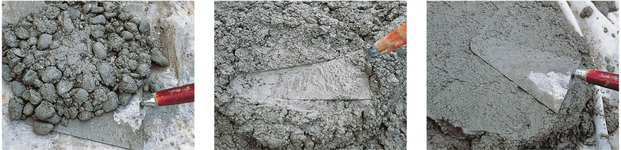
Abb. 1.3.15: Frischbeton mit: zu geringem Anteil an feiner Gesteinskörnung (links), optimalem Anteil an feiner Gesteinskörnung (Mitte), zu hohem Anteil an feiner Gesteinskörnung (rechts).
