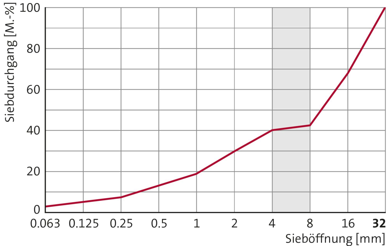
Abb. 1.3.14: Unstetige Siebkurve mit einer Ausfallkörnung für die Korngruppe 4–8 mm (logarithmische Darstellung).
