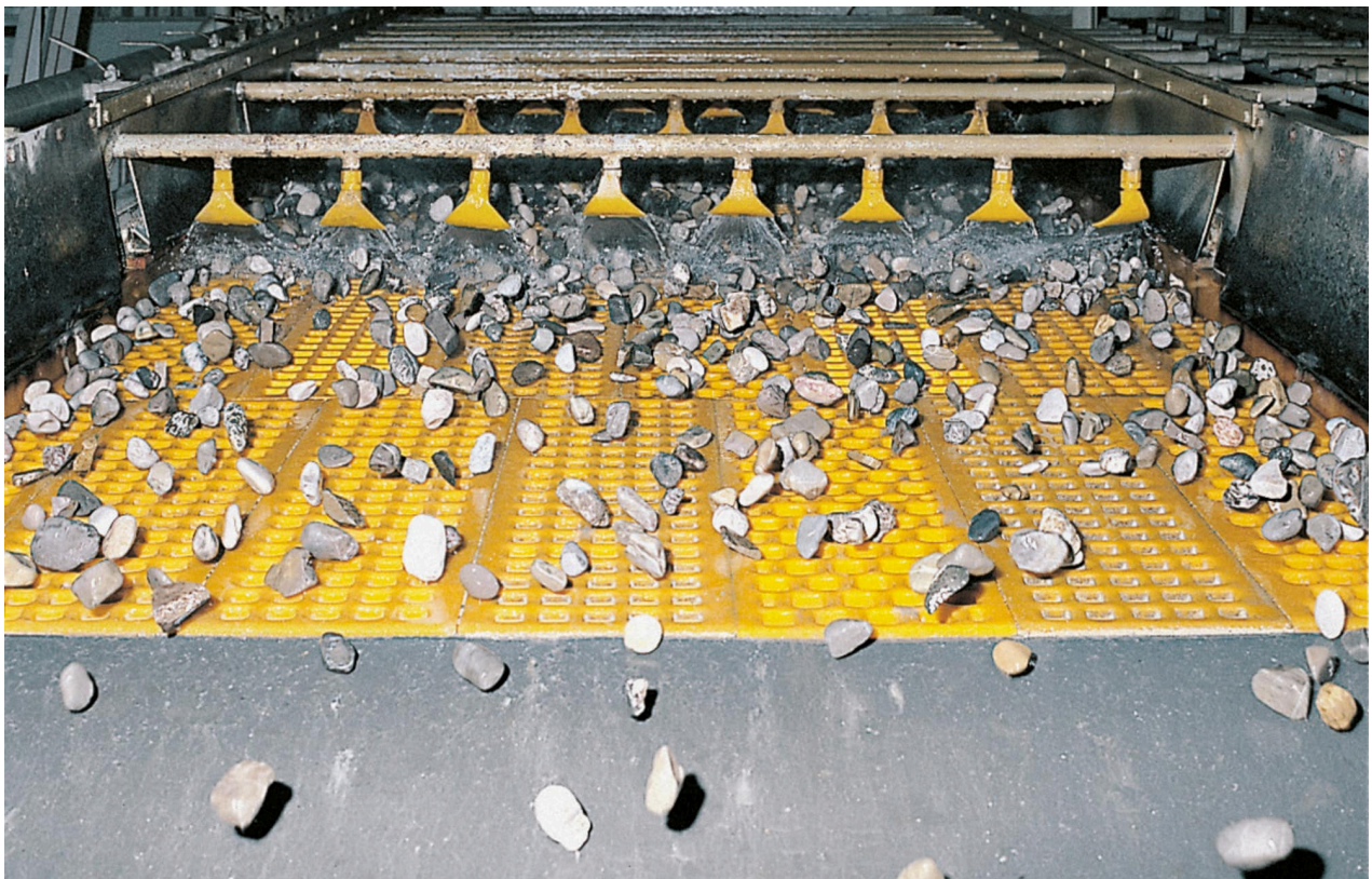
Abb. 1.3.10: Aussieben und Waschen von Gesteinskörnern im Kieswerk.
