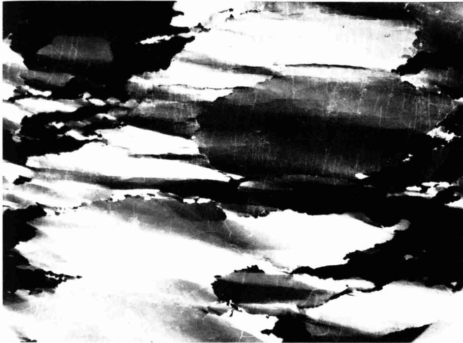
Abb. 12. Quarzgefüge einer Linse in Glimmerschiefer, Steinbruch Castione, Riviera (Gef 17). Vergrößerung 10\times . Man beachte die starke Undulation, die Kluftrisse und die schief zur Undulation verlaufenden Deformationslamellen (besonders gut sichtbar im Korn rechts unten)
