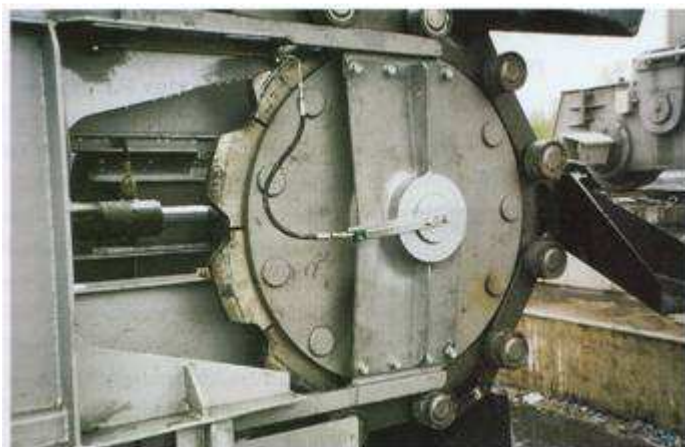
Das im Portalkratzer eingebaute selbsteinstellende Kettenrad
