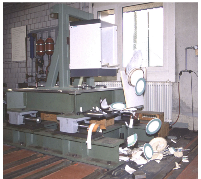
Abb. 5: Typenprüfung eines Küchenschrank-Schliessmechanismus für Japan auf dem Rütteltisch der Sulzer Innotec in Winterthur
