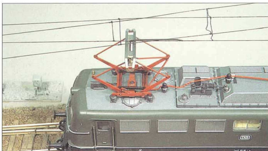
Weg vom dicken Fahrdrabt. Kein Verhau über den H0-Gleisen! Rolf Knipper hat sich für eine Selbstbau-Oberleitung mit nur 0,15 mm starken Drähten entschieden. Foto: Rolf Knipper
