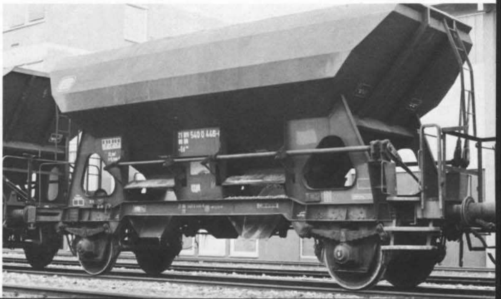
Bild 5: Ein Wagen der Gattung Ed 084 mit gekrüppeltem Langträger.
