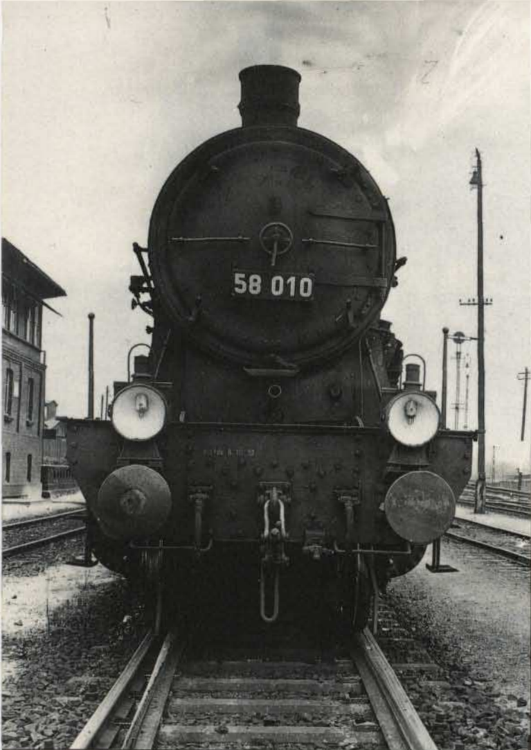
Bild 11: Die Pufferbohlenanschrift der 58 010 (preuß. G 12 1 ) trägt die Aufschrift: Untersuchung Paderborn 8.10.32. Auffällig die hohe Pufferbohle.
