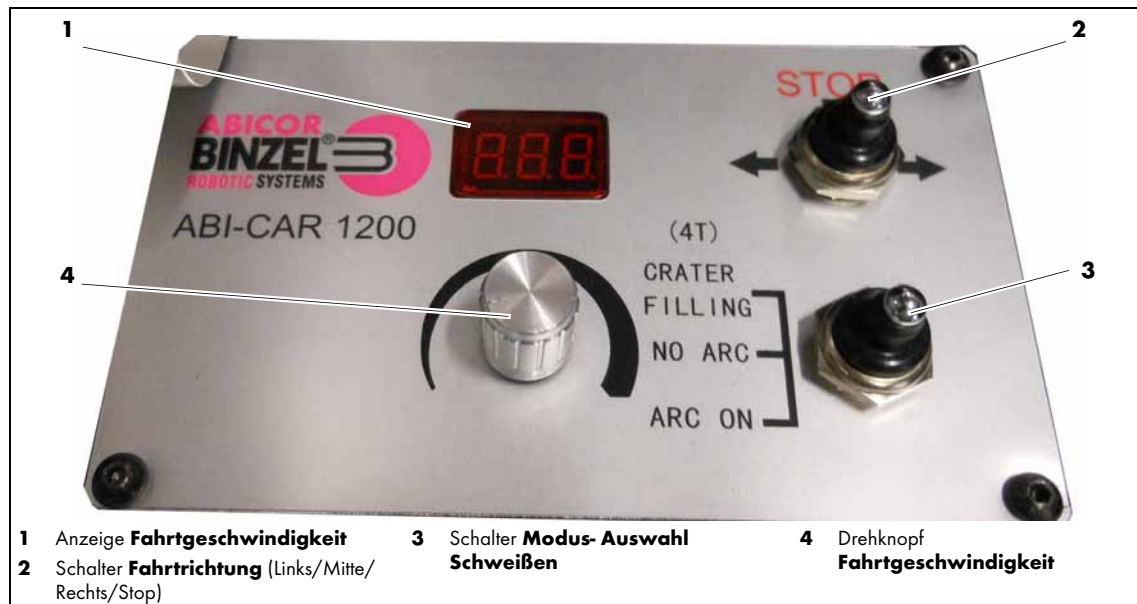
Abb. 15 Bedienelemente ABI-CAR E-1200
