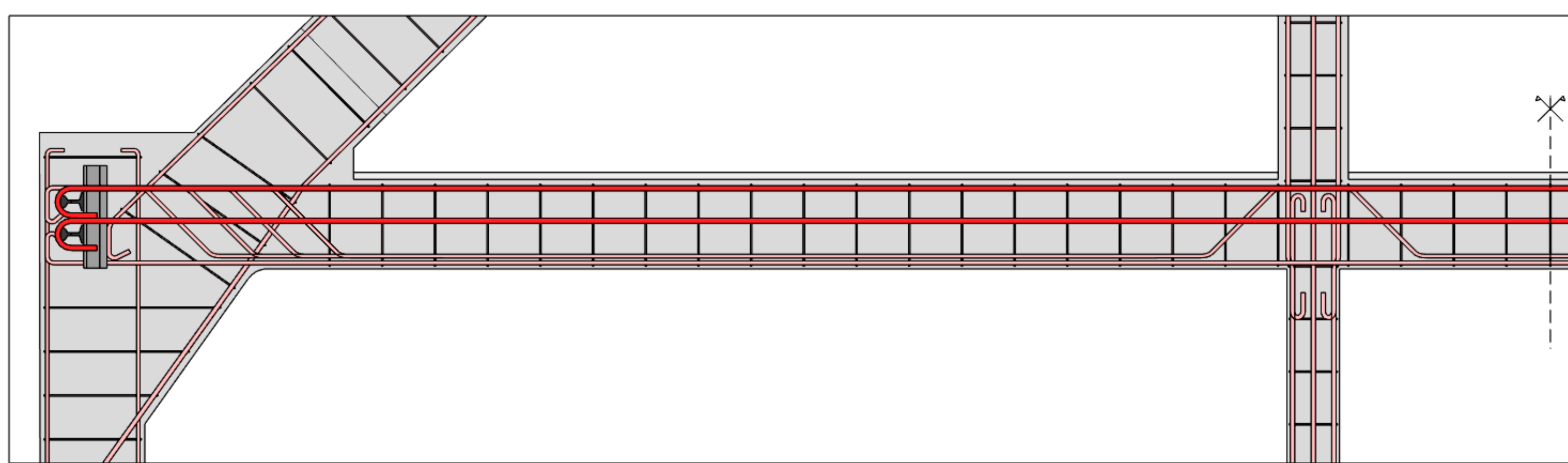
Längsschnitt des bestehenden Zugbandes
