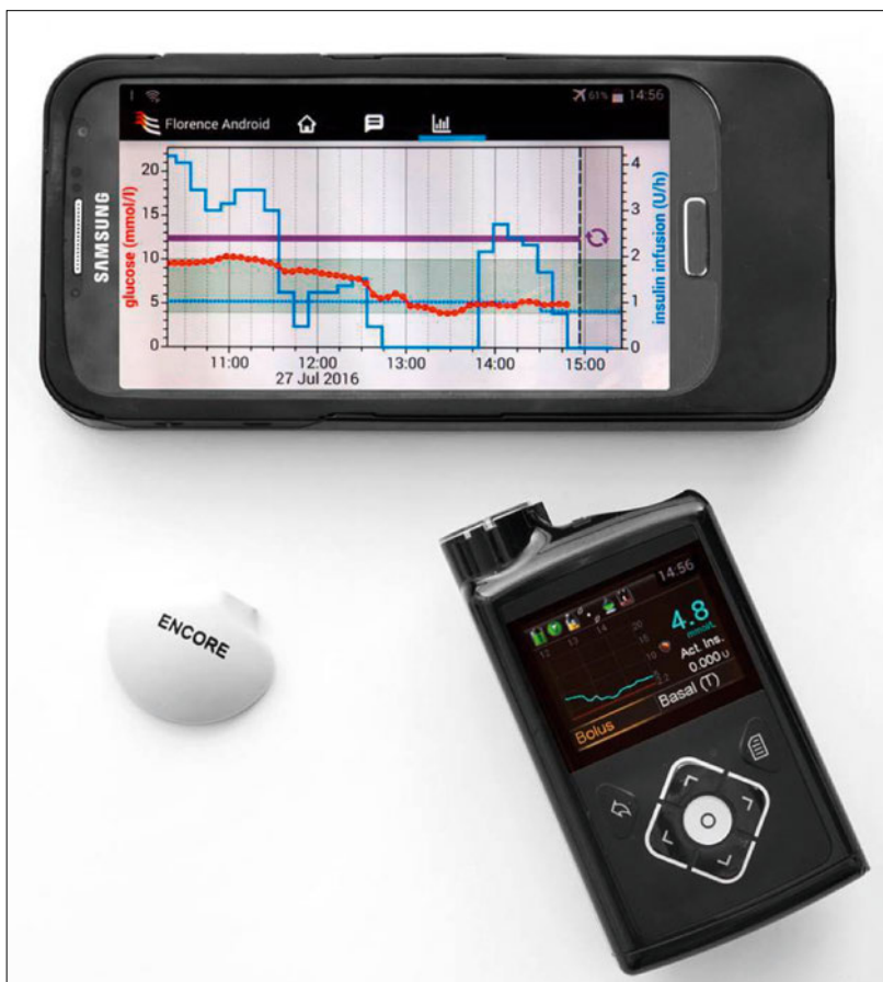
Abbildung 5: Florence M Hybrid-Closed-Loop-System mit Kontrollalgorithmus auf einem Smartphone (Forschungs-Prototyp; Abdruck mit freundlicher Genehmigung von Dr. Roman Hovorka, Universität Cambridge, UK).
