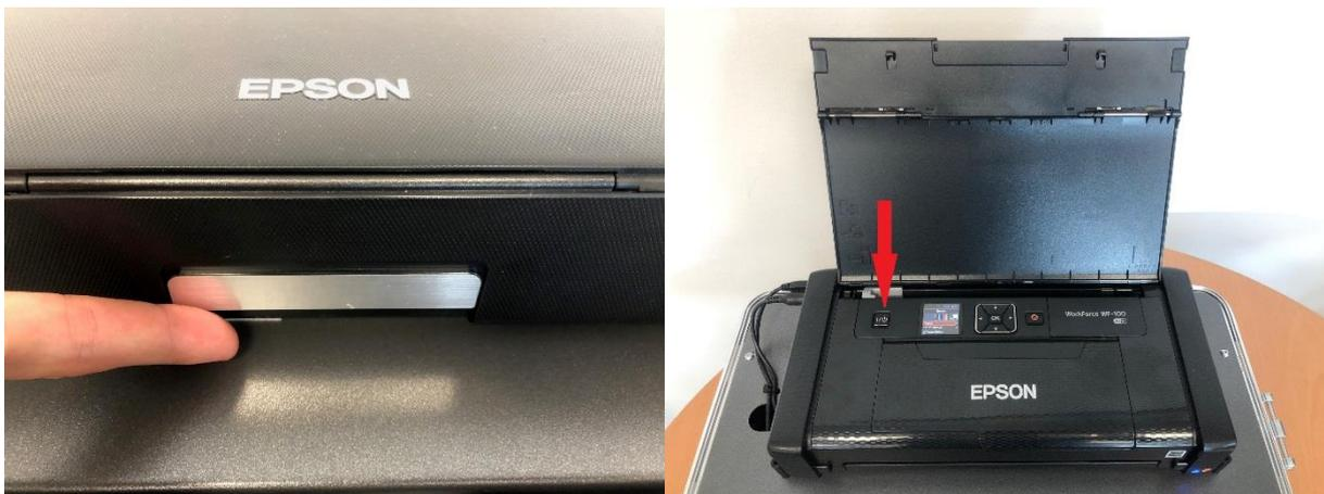
Öffnen Sie den Drucker an der silbernen Lasche und klappen Sie diese nach oben. Achten Sie darauf, dass die Papierführung auf A4 steht. Schalten Sie den Drucker am Startknopf ein.
