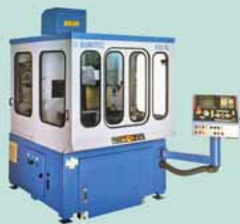
Bumotec S-92XL, CNC mit 3 bis 5 Achsen in Konfigurationen mit einer oder mehreren Spindeln, hergestellt in den frühen 1990er-Jahren
