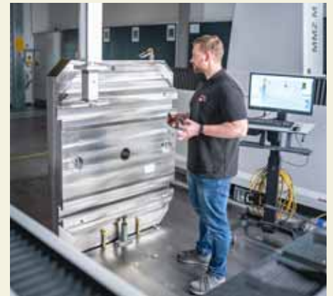
Entkoppelt vom Messablauf: Statt nur einer Station gibt es vier ZEISS-Programmierarbeitsplätze, auf denen vier Fachleute mit dem Programm ZEISS CALYPSO auf Basis von CAD-Daten Messprogramme erstellen.
