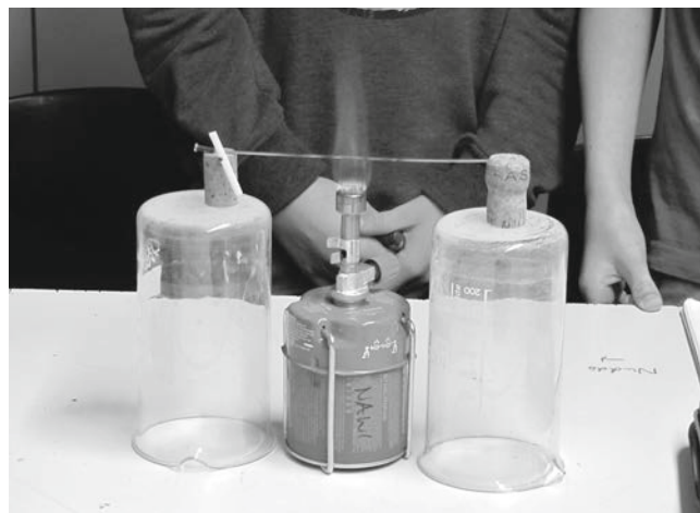
Schülerexperimente zur Längenausdehnung, Fotos: Lutz Rosenhagen
