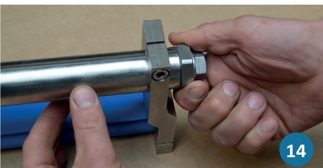
14 Das Gegenlager oder das zweite Torsionselement mit Montagefett in die Gegenseite einführen. Bei der verstärkten Ausführung wird hier auch ein Torsionselement mit Klemmkonus montiert (Schritt 6-9 & 12-13).
