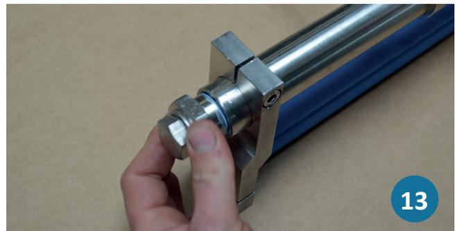
12 13 Das Montagefett auf die O-Ringe des Torsionselementes auftragen und dieses in die passende Seite des Tragrohres einschieben.
