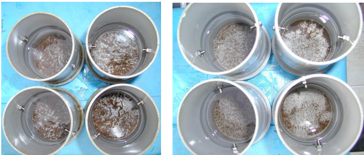
Abb. 3-3: Sedimentfallen nach 3,5 Wochen Expositionsdauer (links: RCS5 – Hafenbereich, rechts: RCS 3 – Südbereich)
