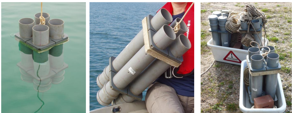
Abb. 3-2: Schwebstofffallen beim Einsatz im Cospudener See
