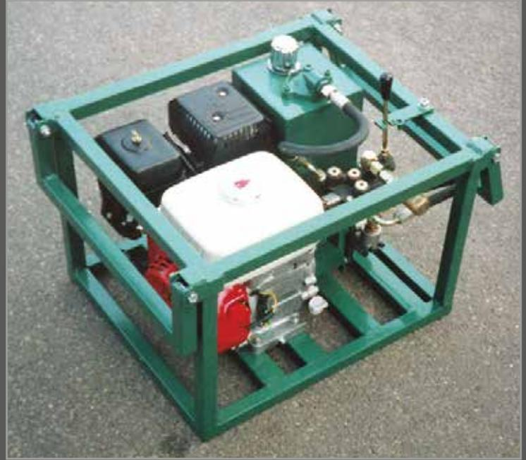
Motorhydraulikaggregat anstatt der Handpumpe für die hydraulische Ausziehvorrichtung.
