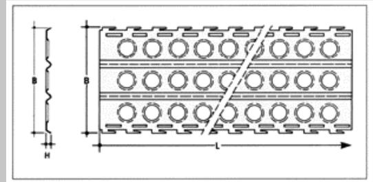
**Geh- und Fahrplatten aus LD-PE-Recycling-Kunststoff,**
