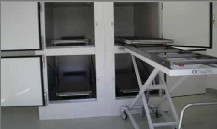
**Hub- und Transportwagen 50/100** zur Beschickung von Leichenkühlzellen mit Rollenbahn.
