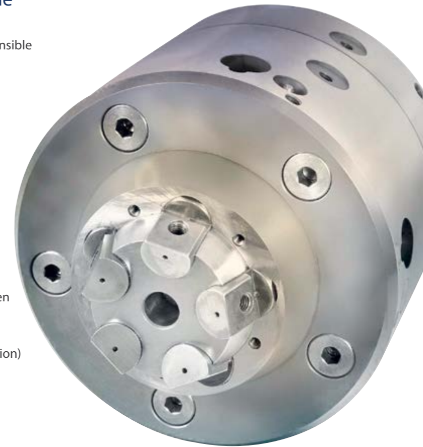
SBF, innenspannend, mit 5 Spannbacken. Aufgrund ihres speziellen technischen Aufbaus können die hydraulischen Ausgleichsfutter auch mit 5 und mehr Spannbacken gebaut werden.
