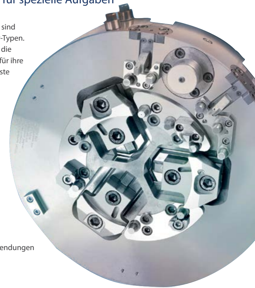
Kombiniertes Sonderfutter auf Keilhakenbasis, für dünne Aluminiumteile: mit Fliehkraftausgleich, abklemmbaren Abstützungen und vielen weiteren Funktionselementen
