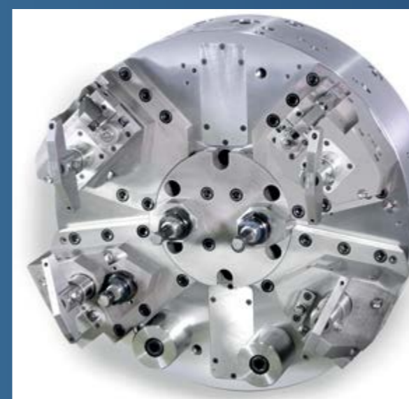
Realisierung von zwei Folgeoperationen in einem Spannfutter
