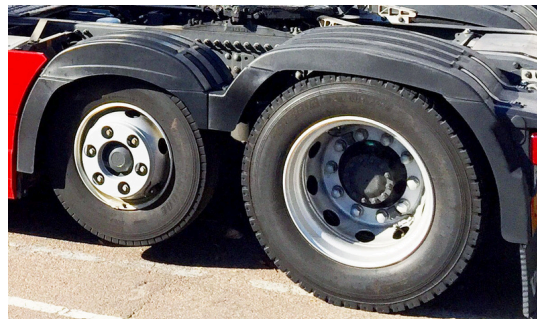
Die 4,5-Tonnen-Vorlaufachse des RAPD-G4 Achsaggregats ist mit kleineren Rädern ausgerüstet.
